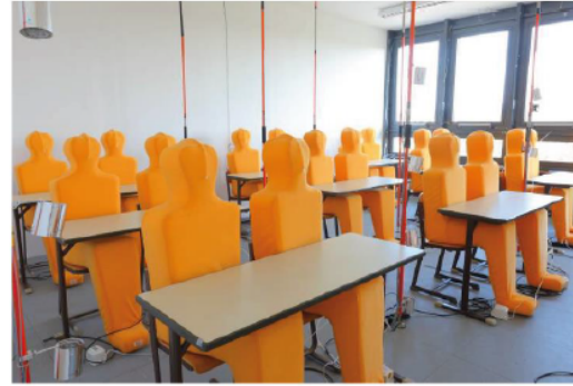
Ansicht des Klassenraumes im Versuchsgebäude des Fraunhofer IBP, Quelle: Steiger, S.; Hellwig, R.T.: Hybride Lüftungssystem für Schulen , Abschlussbericht Fraunhofer IBP, 2011
