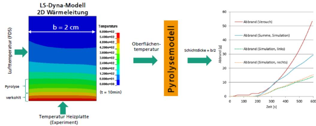
Der experimentell gemessene Abbrand kann bei Verwendung korrekter Holztemperaturen an der Oberfläche sinnvoll abgebildet werden
